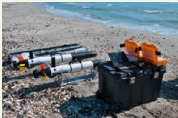
Φωτογραφίες 3 και 4 — Όργανα σόναρ που χρησιμοποιούνται στη θαλάσσια χαρτογράφηση
